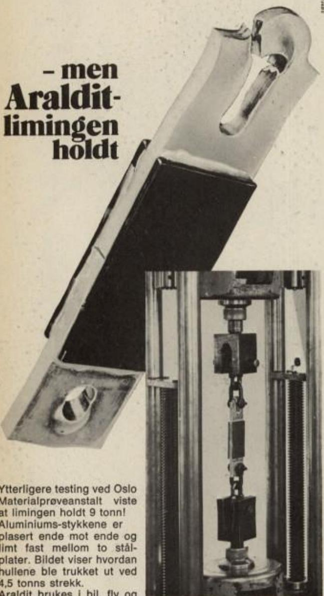
Ytterligere testing ved Oslo Materialprøveanstalt viste at limingen holdt 9 tonn! Aluminiums-stykkene er plasert ende mot ende og limt fast mellom to stålplater. Bildet viser hvordan hullene ble trukket ut ved 4,5 tons strekk.
